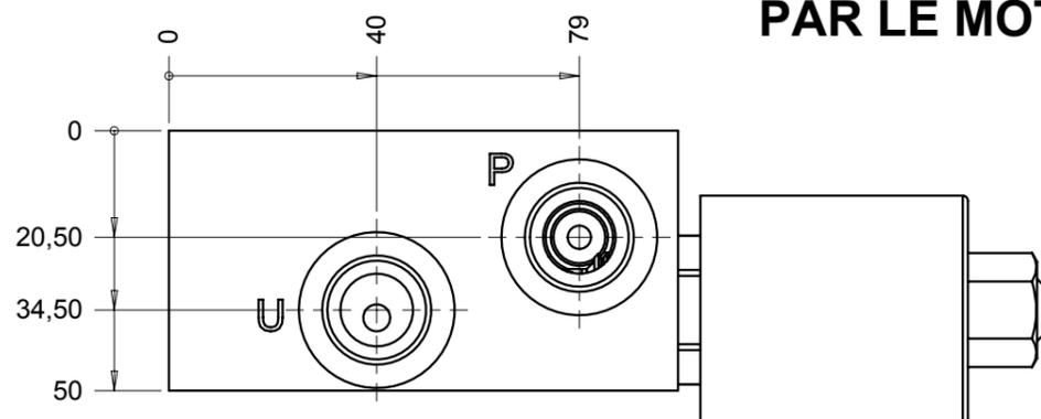
Les orifices P, T et U sont en 1/2" Gaz cylindrique.
