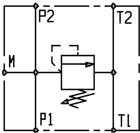
Les orifices P1,P2,T1 et T2 : 3/4" gaz cyl
