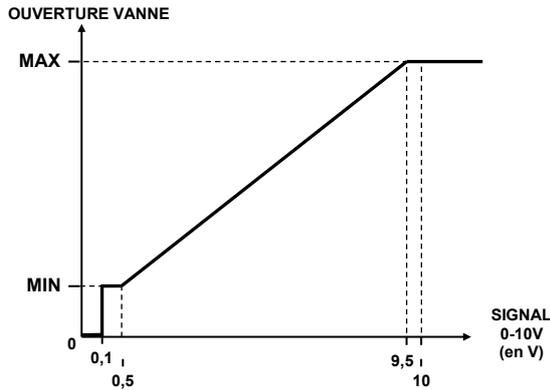
**Réglage de l'ouverture MIN :** Régler le signal 0-10V sur 0.3V. Régler l'ouverture minimale avec le potentiomètre MIN de la face arrière.
